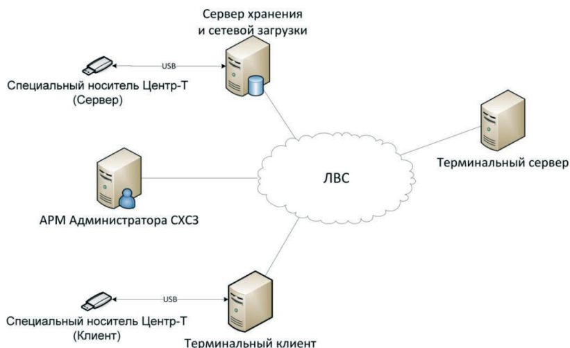
Рисунок 43 – Схема решения «Центр-Т»
