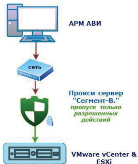
Рисунок 39 – Принцип работы «Сегмент-В.»
