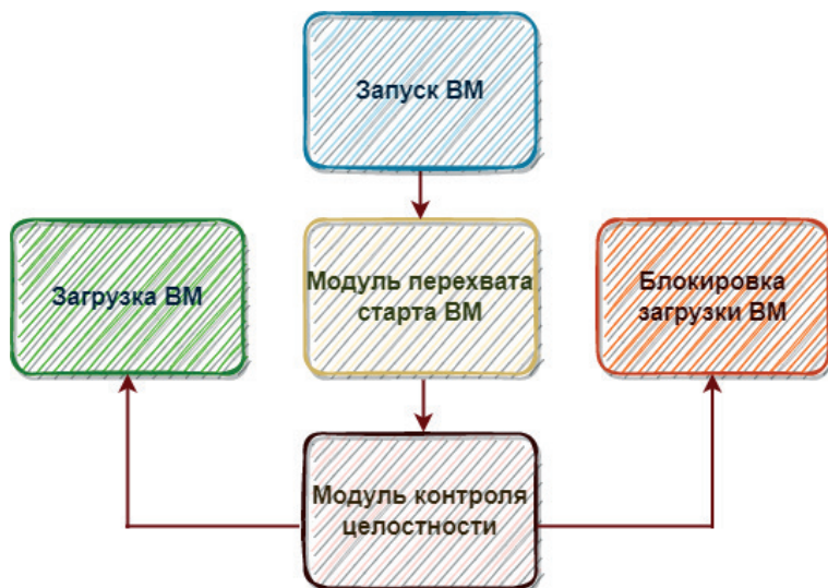
Рисунок 34 - Принцип работы СПО «Аккорд-KVM»
