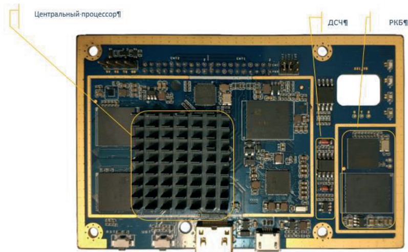
Рисунок 40 - Общий вид микрокомпьютера m-TrusT (универсальный модуль мезонин)
