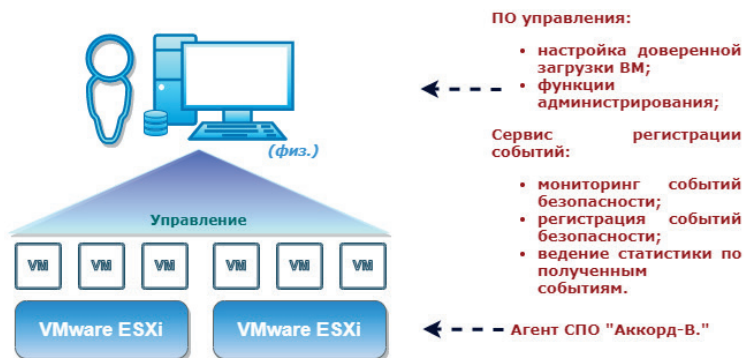
Рисунок 35 – Схема взаимодействия СПО «Аккорд-В.»
