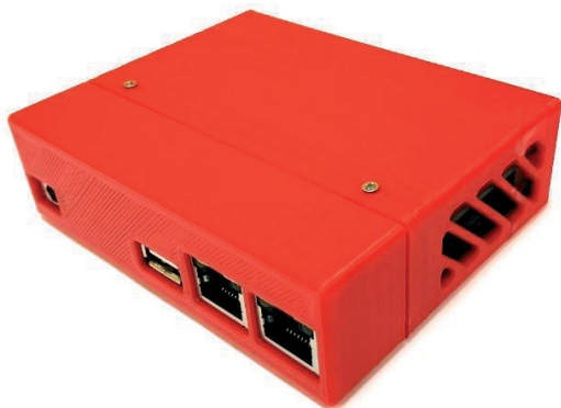
Рисунок 15 - Вариант исполнения криптошлюзов fin-Trust в корпусе
