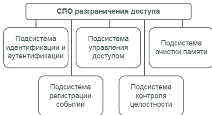
Рисунок 42 - Подсистемы СПО разграничения доступа
